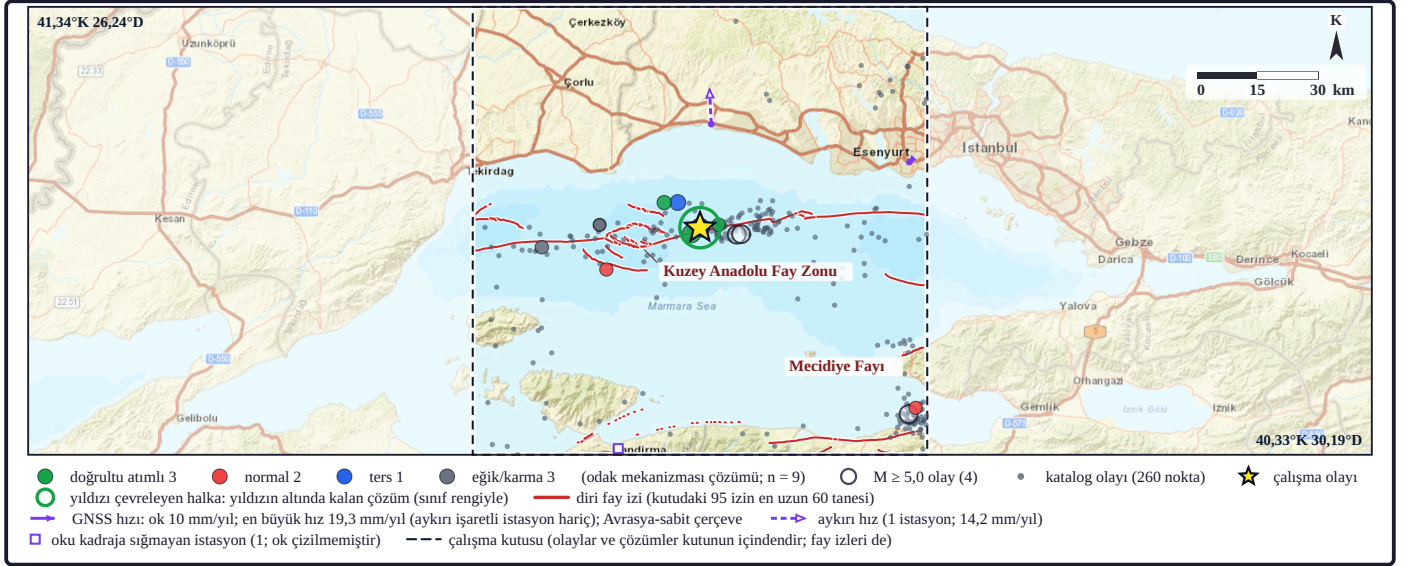
Şekil 11. Haritada odak mekanizması çözümleri, diri fay izleri ve GNSS hız vektörleri birlikte gösterilmiştir. Renkli dairelerde renk mekanizma sınıfını, çap büyüklüğü kodlar. Kırmızı çizgiler haritalanmış diri fay izleridir; dış merkeze en yakın adlı faylar harita üzerinde adlandırılmıştır. Mor oklar GNSS istasyonlarının yatay hız vektörleridir (başvuru oku ve en büyük hız lejantıdır). İçi boş halkalar M \geq 5,0 olayları, küçük gri noktalar katalog sismisitesini, sarı yıldız çalışma olayının dış merkezini gösterir (GCMT mekanizmaları; GNSS: Nevada Geodetic Laboratory [NGL] MIDAS hızları, Blewitt vd., 2016, 2018; Avrasya-sabit çerçeve: GSRM v2.1, Kreemer vd., 2014; faylar: MTA TDFH-2026 [Elmacı vd., 2026]).
