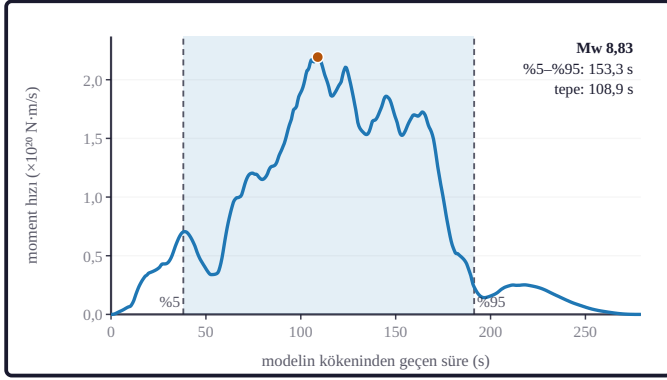
Şekil 7a. Eğri USGS sonlu fay modelinin (sürüm 5; gözden geçirilmiş ürün; 19.11.2025) moment hızı fonksiyonudur; zaman modelin kendi kökenine göre; modelin toplam sismik momenti M_0 = 2,25 \times 10^{22} N·m, M_w 8,83; gölgeli bant birikimli momentin %5'ine (38,1 s) ve %95'ine (191,4 s) ulaşılan anlar arasıdır; aradaki süre (moment salınımının %90'ının gerçekleştiği süre) 153,3 s'dir; dolu daire en büyük moment hızıdır: 2,2 \times 10^{20} N·m/s, 108,9 s'de; eğri ters çözümün model çıktısıdır, ölçülmüş bir zaman serisi değildir (kurum ürünü: USGS sonlu fay modeli [U.S. Geological Survey, 2017]; yöntem: Ji vd., 2002).
