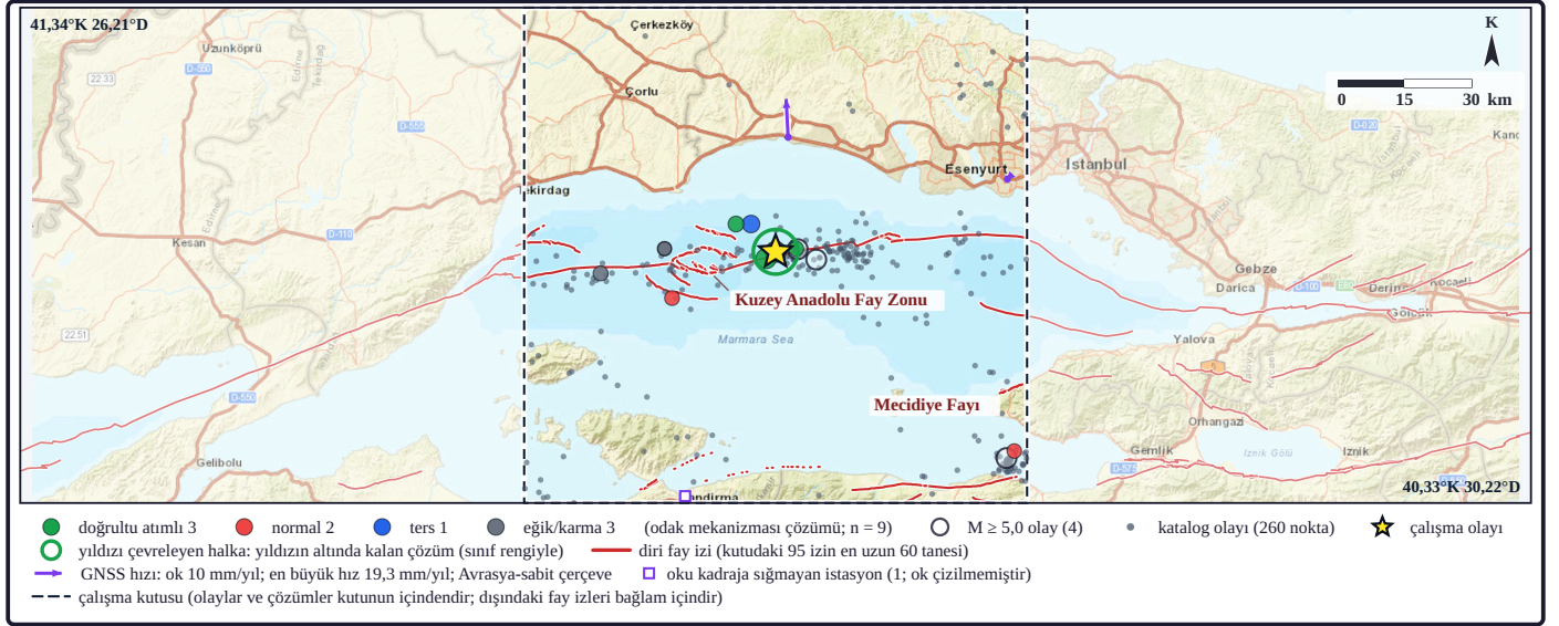
Şekil 9. Haritada odak mekanizması çözümleri, diri fay izleri ve GNSS hız vektörleri birlikte gösterilmiştir. Renkli dairelerde renk mekanizma sınıfını, çap büyüklüğü kodlar. Kırmızı çizgiler haritalanmış diri fay izleridir; dış merkeze en yakın adlı faylar harita üzerinde adlandırılmıştır. Mor oklar GNSS istasyonlarının yatay hız vektörleridir (başvuru oku ve en büyük hız lejantıdır). İçi boş halkalar M \geq 5,0 olayları, küçük gri noktalar katalog sismisitesini, sarı yıldız çalışma olayının dış merkezini gösterir (GCMT mekanizmaları; GNSS: Nevada Geodetic Laboratory [NGL] MIDAS hızları, Blewitt vd., 2016, 2018; Avrasya-sabit çerçeve: GSRM v2.1, Kreemer vd., 2014; faylar: MTA TDFH-2026 [Elmacı vd., 2026]).
